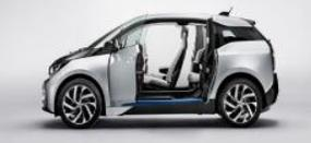
Sa construction associe une cellule en CFRP (composite polymère/carbone) sur un châssis en aluminium avec un habitacle partiellement habillé de matériaux recyclés.
